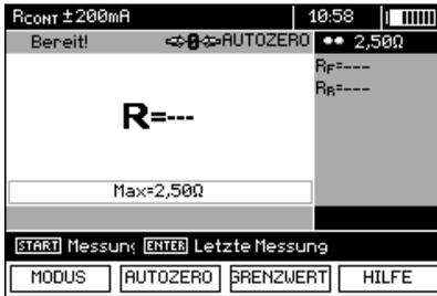
Die Aufschrift **AUTOZERO** erscheint, was bedeutet, dass die Messkabel geeicht wurden.
