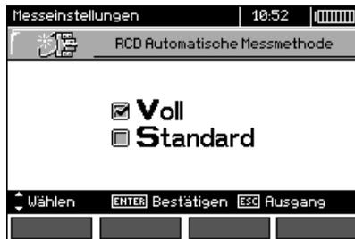
Im Standard-Modus werden die Messungen für die gewählte Form des Stroms durchgeführt, in vollem Modus für alle Stromformen für die jeweilige RCD-Art (AC, A, B, B+, F).
