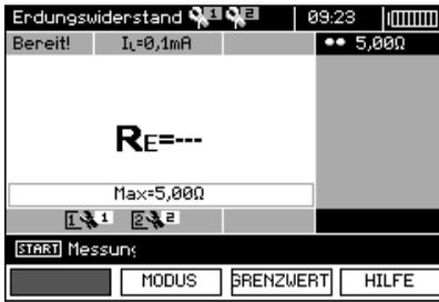
Das Messgerät ist für die Messung bereit. Auf dem Display kann der Wert des Leckstroms, der durch die Klemmen fließt abgelesen werden.
