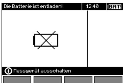
Akkus/Batterien sind extrem schwach, Messung wurde blockiert.
