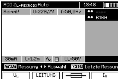
Das Messgerät ist für die Messung bereit. Auf einem Display kann der Wert der der Spannung und Frequenz abgelesen werden.
