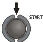
Die Taste **START** drücken, um die Messung einzuleiten. Wenn Messungen gewählt wurden, die der Auslösung der RCD-Schalter bedürfen, begeben Sie sich in die direkte Nähe des Schalters und schalten Sie ihn nach jedem Auslösen ein, bis die Messungen abgeschlossen sind (eine längere Pause kann auf das beenden der Messung deuten).
